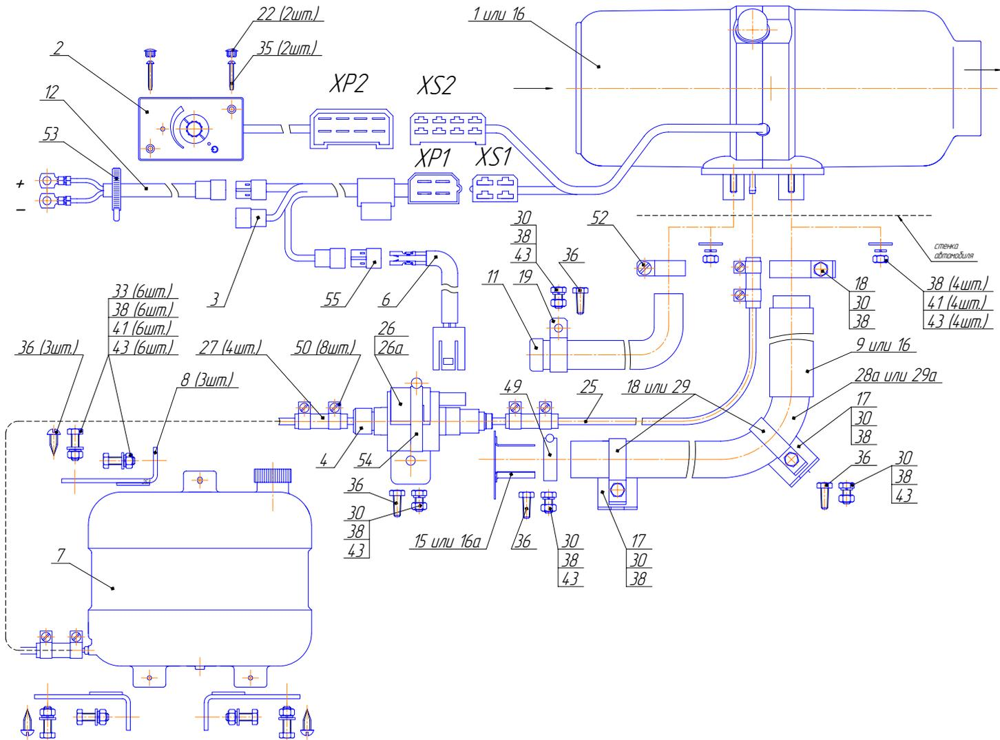
Рис.1- Схема деления воздушного отопителя на составные части.
