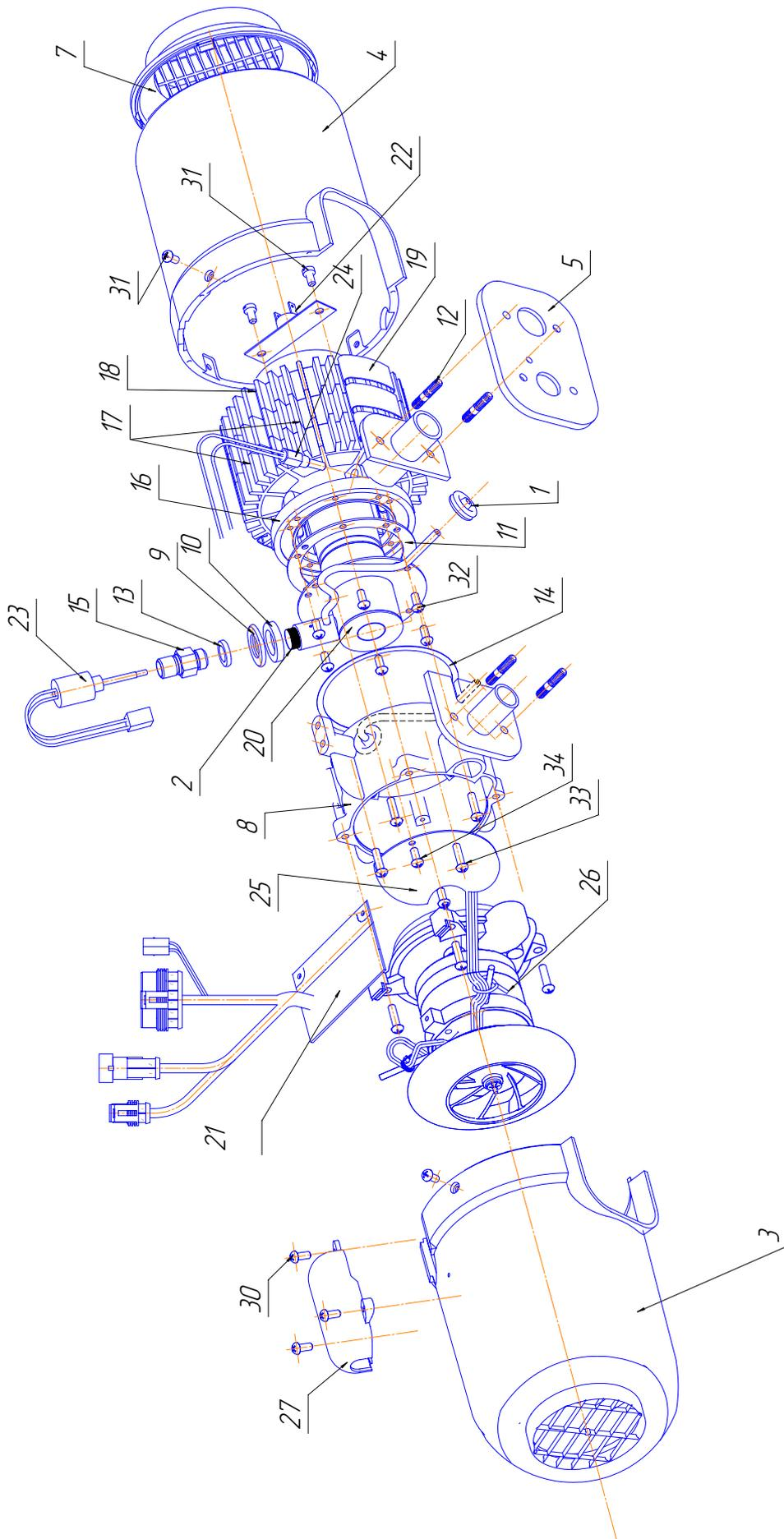
Рис.5-Схема деления нагревателя (для ПЛАНАР -4ДМ2-12/24) на составные части.
