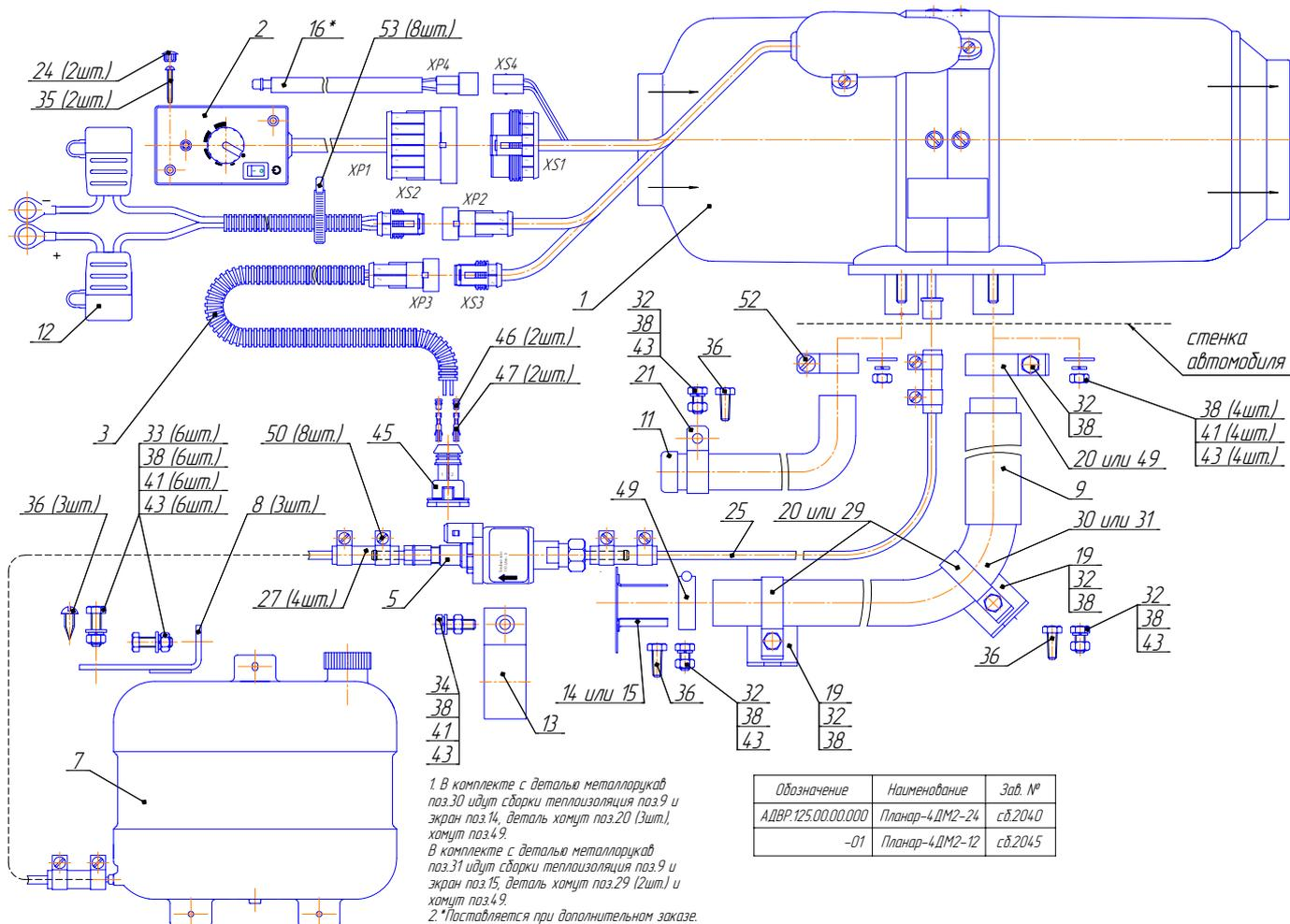
Рис.4- Схема деления воздушного отопителя на составные части
