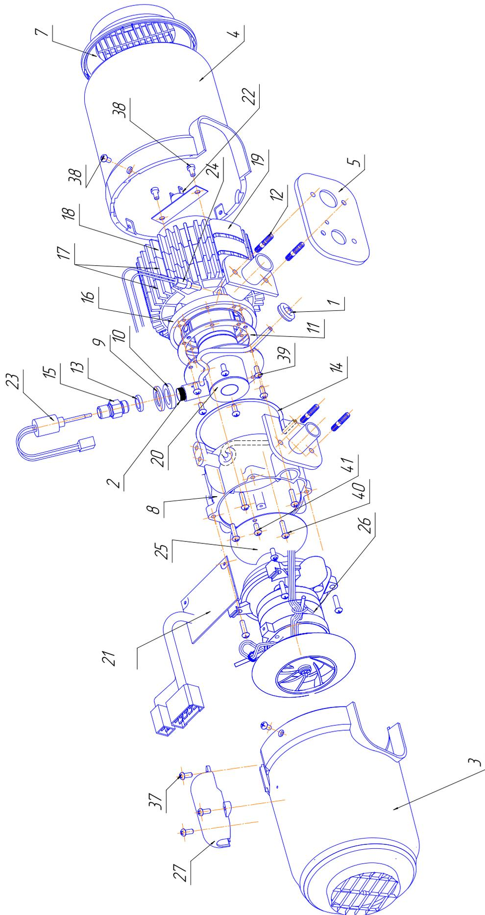
Рис.3-Схема деления нагревателя (для ПЛАНАР -4ДМ-12/24) на составные части.
